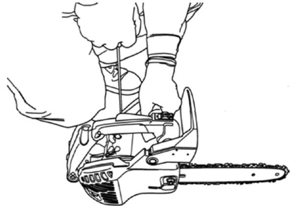
6. Si le moteur cale après le premier essai, appuyez sur le bouton de l'enrichisseur pour le remettre dans sa position initiale et tirez de nouveau la poignée du démarreur.
