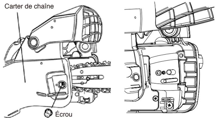
3. Retirez la vis du guide-chaîne. Retirez l'attrape-chaîne et le guide-chaîne.
