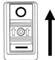
Remarque: Si le moteur ne s'arrête pas dans la position "○", tirez le "BOUTON DE L'ENRICHISSEUR" pour l'arrêter. Si la chaîne continue à tourner après que vous avez tiré le bouton de l'enrichisseur, lorsque le moteur est en fonctionnement, faites immédiatement réviser la scie à chaîne auprès d'un distributeur agréé.
