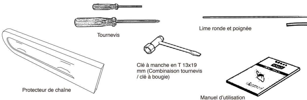
**Protecteur de chaîne** : Dispositif amovible couvrant le guide-chaîne et la chaîne durant le transport et le remisage de la scie.
