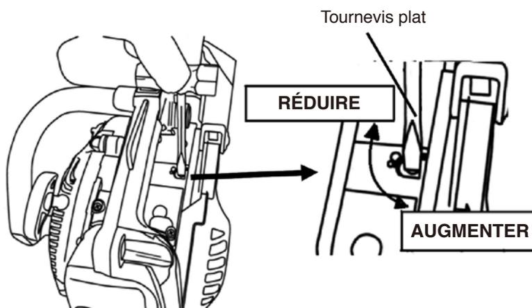
Pour augmenter le volume de déplacement, faites tourner la vis de réglage dans le sens anti-horaire.
