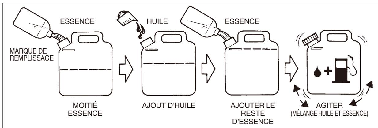
Lors du remplissage du réservoir de la scie à chaîne, nettoyez le pourtour du bouchon afin d'éviter l'introduction de débris et de saletés au moment de son dévissage. Secouez le bidon de mélange de carburant quelques instants avant de remplir le réservoir de carburant.
