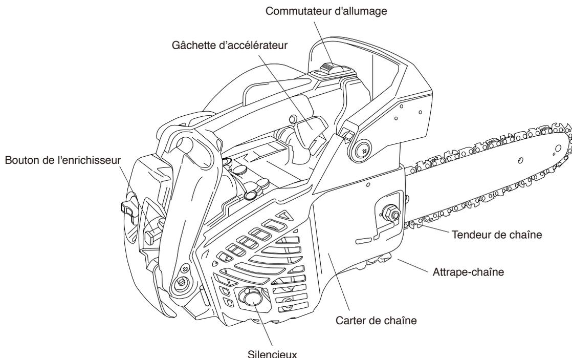
**Bouton de l'enrichisseur** : Dispositif permettant d'enrichir le mélange carburant/air à l'intérieur du carburateur pour faciliter le démarrage à froid.
